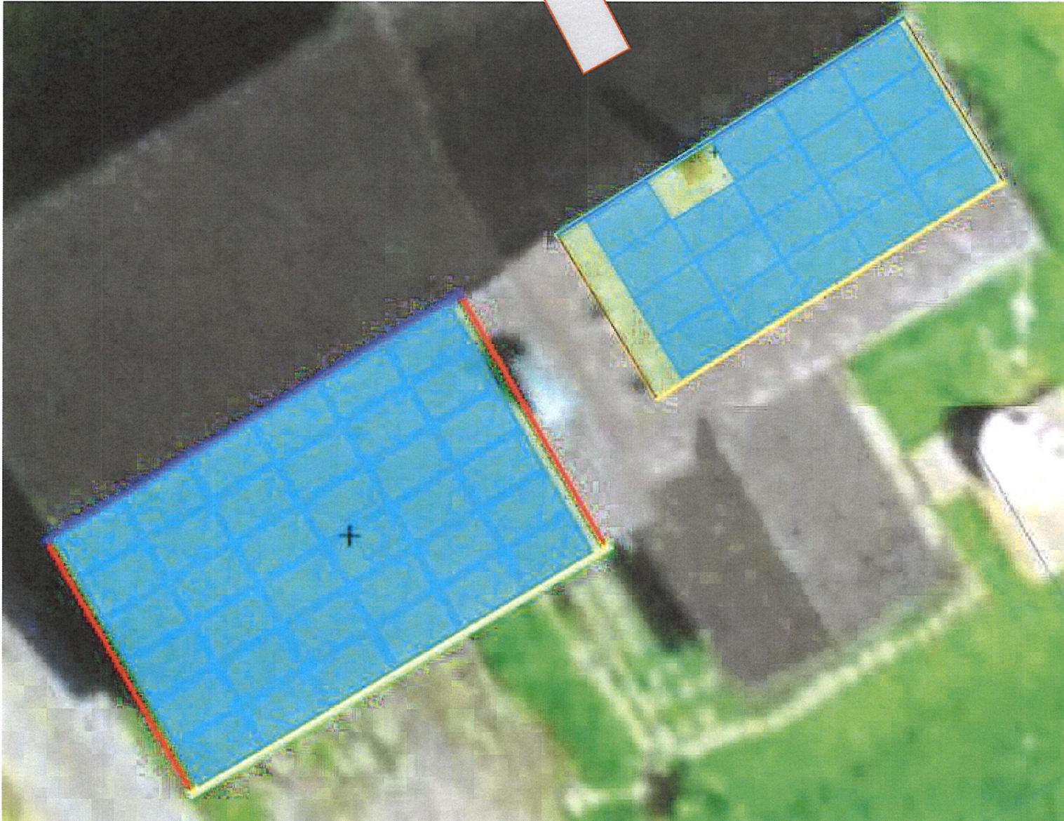
PV KAUF: Modulplan 55 Module / 22 kWp / 101 m<sup>2</sup>
